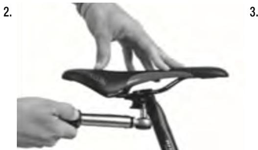
Apriete ambos tornillos progresivamente y en el sentido de las agujas del reloj alternativamente, sin exceder el par de bloqueo máximo permitido.
