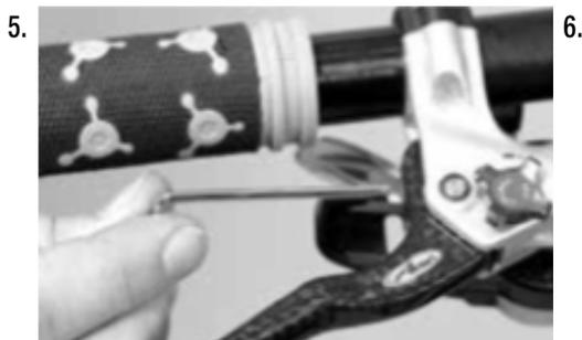
Ajustes para la distancia de la palanca de freno al manillar.
